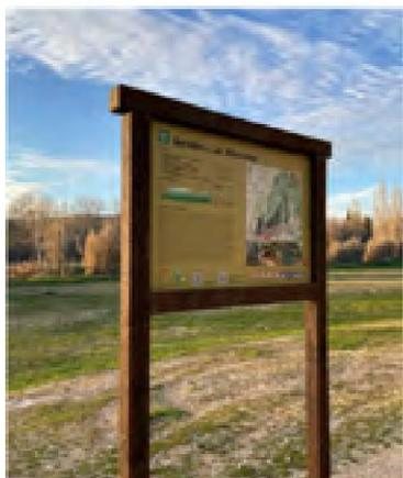
CARTEL INFORMATIVO. 100% reciclado y reciclable. Estructura formada por perfiles cuadrados con alma metálica, Soporte gráfico formado por placa de aluminio-dibond composite de 3 mm de espesor, e información a 1 cara rotulada con vinilo polimérico laminado UV y con protección anti-graffiti. Tornillería de acero cincado.
