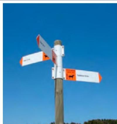
Señal de plancha de aluminio de 3 mm de espesor, lacada en blanco con impresión de textos y gráficos en vinilo para exterior y elementos de anclaje a poste de madera de 10 cm de diámetro.
